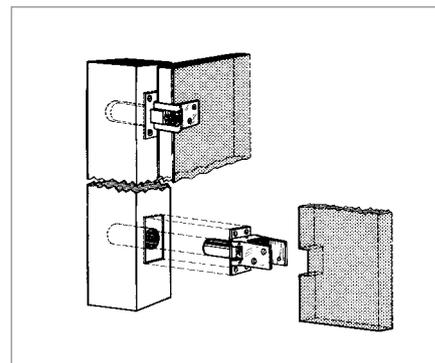
Le cerniere DICTATOR tipo "HAWGOOD" si distinguono per la qualità dei materiali impiegati e per il loro concetto di funzionamento inventato dalla DICTATOR TECHNIK, che le rende adatte all'utilizzo in situazioni di traffico intenso. Sono cerniere portanti, a ritorno automatico bidirezionale. Possono essere fornite con o senza fermo porta a 90°. Le cerniere tipo "HAWGOOD" vengono fornite in esecuzione inox per ambienti umidi o aggressivi.
