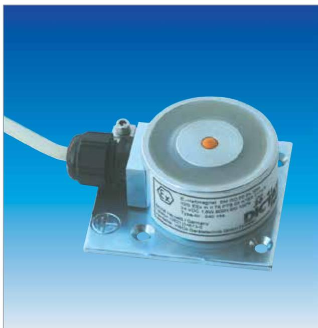
Per mantenere bloccate le porte viene utilizzato un elettromagnete ad aderenza Ds DICTATOR della serie EN GD 70 con forza di tenuta 1450N certificato per impianti antideflagranti.
