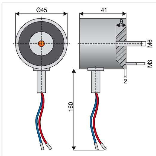
Elettrocalamita DICTATOR ECD funziona senza corrente elettrica; l'elettrocalamita è magnetica e ha una forza di tenuta pari a 120 N (12 Kg).
