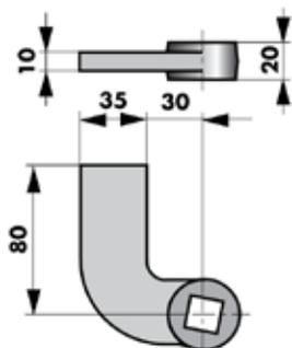
Cerniera inferiore da saldare
