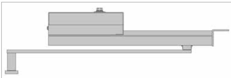
Il Dictamat 655 è un chiudiporta aereo per portoni antincendio a battente di grandi dimensioni con forza di 250 Nm. È dotato di elettrofreno di blocco in massima apertura con angolo di apertura fino a 210°, chiusura a velocità regolabile e possibilità di arresto di emergenza tramite pulsante di "stop" e/o fotocellule (conforme al D.L. 81 allegato IV). Larghezza max porta 4000 mm, peso max 500 Kg.
