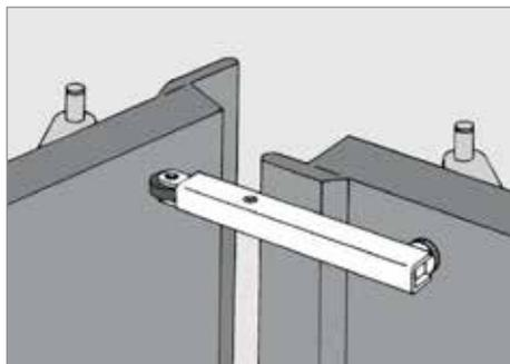
Il preselettore secondario DICTATOR MK 90 serve per evitare l'incastro in apertura di porte a doppio battente antincendio dotate di preselettore principale DICTATOR, se queste vengono aperte con un angolo d'apertura insufficiente ad azionare il preselettore principale.
