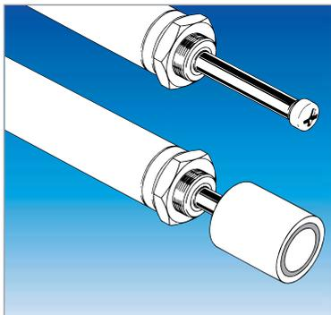
Gli ammortizzatori DICTATOR EDH 35 sono ammortizzatori idraulici per masse d'urto con velocità fino a 2 m/sec. La corsa relativamente lunga dello stelo (fino a 500 mm) consente una decelerazione lenta e dolce fino alla posizione di fine corsa.
