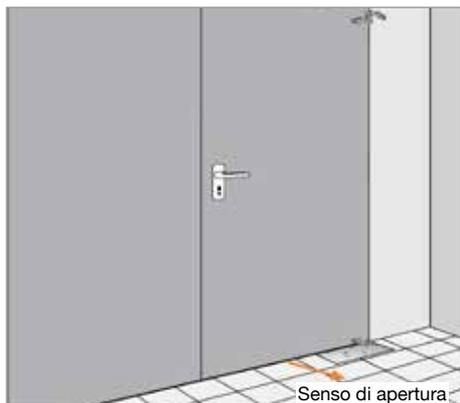
Il chiudiporta DICTATOR WAB 180 si monta con la propria cassa murata nel pavimento con piastra di copertura in alluminio, lamiera zincata o acciaio inox con le proprie camere e piastre.
