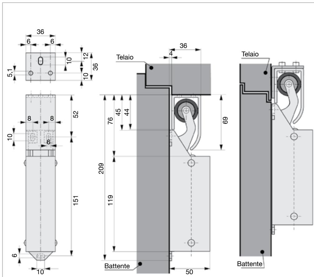
Il chiuditore deceleratore Dictator R1400 Design con il suo carter avvolgente è stato studiato per montaggio lato spingere della porta con riscontro posizionato sul telaio e corpo chiudiporta sullo spigolo superiore sopra alla porta lato opposto alla cerniera in verticale o orizzontale. E' disponibile con forza di chiusura da 20-50-80 N con decelerazione regolabile in acciaio cromato argento ottone bianco marrone o nero oppure in acciaio INOX.
