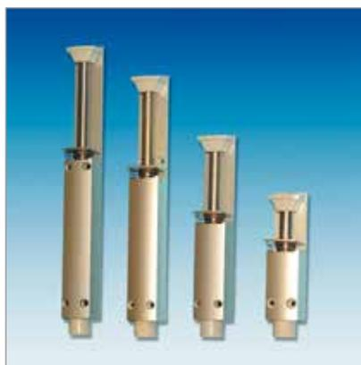
I fermo porta DICTATOR ZE si distinguono dalla ferramenta comune per la qualità e l'affidabilità degli stessi che consente una lunga durata nel tempo. Sono forniti in 4 versioni con corsa variabile da 25 a 90 mm. Sono prodotti totalmente in acciaio inox con corpo in alluminio trattato e gommato degli arresti e degli azionamenti in termoplastico non deperibile, la scelta dei materiali consente l'installazione e una lunga durata anche in ambienti marini o particolarmente umidi.
