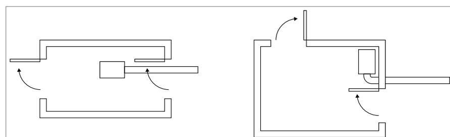
Il pressurizzatore può essere montato a piacere dentro la zona filtro fumo, non come dislocamento standard.
