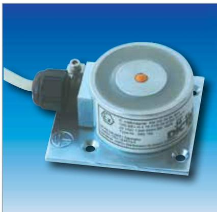
Gli elettromagneti DICTATOR EX antideflagranti sono utilizzati in ambienti a rischio di esplosione in zone di classificazione 0-1-2 per gas, 20-21-22 per polvere. Sono dispositivi compatti composti da elettromagnete, morsetteria antideflagrante, diodo antiscintilla per togliere la corrente indotta in apertura e protezione di polarità.
