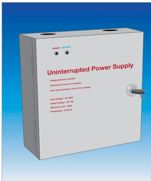
Le centrali di controllo UPSCA consistono in centrali di comando specializzate per il controllo accessi. Hanno funzione di alimentatore con batteria in tampone (su ordinazione). Consentono il collegamento simultaneo di elettropistoni con catenaccio fuoriuscito senza corrente, di elettromagneti ad aderenza o di elettropistoni con catenaccio ritirato senza corrente comandati da pulsantiere a codice, badge, contatti a chiave, pulsanti da postazioni presidiate.
