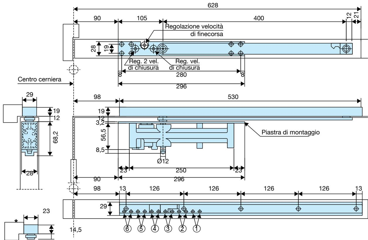
Posizione installazione per angolo di apertura con e senza fermo con decelerazione meccanica e apertura fino a 180°
