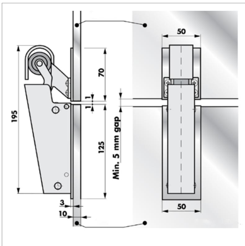
Il chiuditore deceleratore Dictator V1600 prima decelera poi tira mantenendo la porta in trazione, decelerazione regolabile anche per porte già in opera in aggiunta a chiudiporta contro pressione incostante di vento, bussole versione in acciaio INOX forza 20N.
