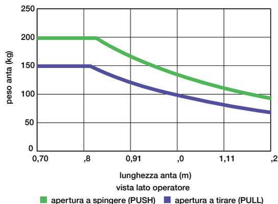
La motorizzazione DS 105 D è una moderna motorizzazione design per porte antincendio dotata di motore in corrente continua con il proprio quadro di comando inserito nella motorizzazione stessa, con logica antincendio con apertura elettrica e chiusura a molla con velocità di chiusura regolabile anche in assenza di corrente. Certificato per uso su porte antincendio.
