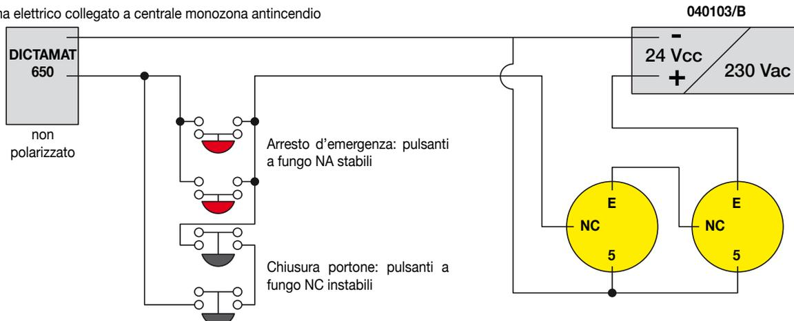
NB: si possono collegare fotocellule con c.n.a. in parallelo ai pulsanti NA a raggio non interrotto alimentazione 24 Vcc in parallelo da schema c.s.
