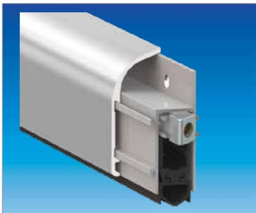
La soglia ad abbassamento automatico viene montata sulla porta lato spingere e viene azionata tramite un pulsante laterale che viene premuto contro il telaio della porta durante il movimento di chiusura.
