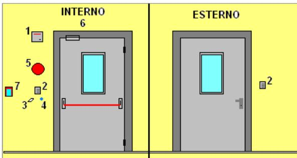
Il malato di mente normalmente tenta la fuga azionando il maniglione antipanico, ma l'impianto Ds Dictator mantiene la porta bloccata da elettromagnete.
