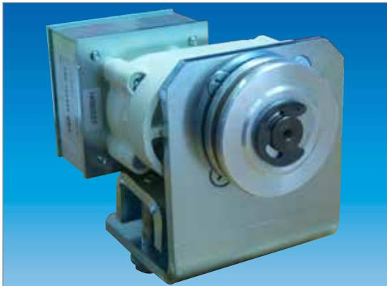
Il Dictamat LD 81 è un elettroblocco funzionale, compatto ed estetico per portoni scorrevoli antincendio a una o due ante a chiusura centrale con regolazione di velocità su tutta la corsa di chiusura del portone a uomo presente ed arresto del portone in una qualsiasi posizione della corsa in cui viene lasciato.
