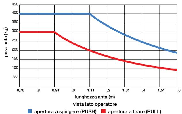
La motorizzazione DS 205 D è una moderna motorizzazione design per porte antincendio dotata di motore in corrente continua con il proprio quadro di comando inserito nella motorizzazione stessa, con logica antincendio con apertura elettrica e chiusura a molla e con motore. Certificato per uso su porte antincendio.
