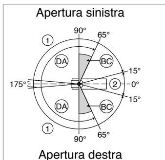
Regolazione della velocità di chiusura tramite le valvole ① ② DA
