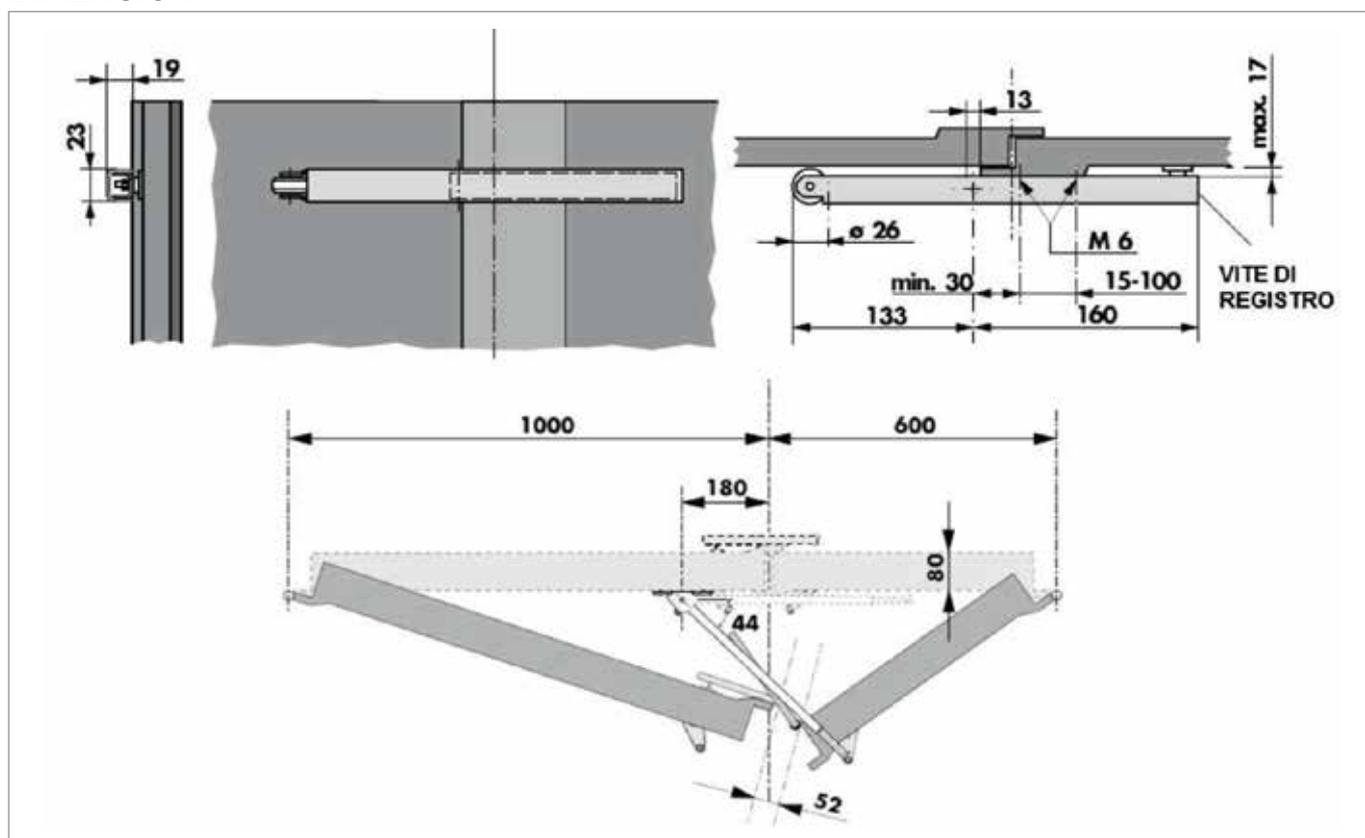
Montare il preselettore secondario sul battente che si deve chiudere per primo sul lato interno del battente a filo dello stesso, in modo che si possa piegare il preselettore secondario a 90°. La sua base di montaggio deve sporgere di minimo 13 mm dal filo del battente.
