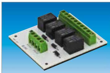
La scheda di controllo SCH-2P serve per l'interblocco di bussole d'ingresso a due porte per gioiellerie, banche, uffici, laboratori. È dotata di morsettiere separate per elettropistone (elettro serrature) con catenaccio rientrato senza corrente, elettromagnete ad aderenza oppure con relé pilota RP 01 può comandare elettropistone (elettro serrature) con catenaccio fuori uscito senza corrente.
