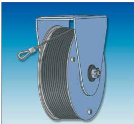
Molle a bobina diametro 177mm esecuzione con funzione antistrappo trazione 100N corsa 4m, con forcella. cavo in kevlar o a richiesta in acciaio.
