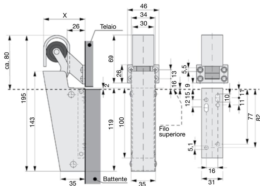
Il chiuditore deceleratore Dictator R1600 Design con il suo carter avvolgente a cerniera senza viti in vista e riscontro con solo 4 viti in vista per montaggio lato tirare della porta in verticale o orizzontale, è disponibile con forza di chiusura 20-50-80-115 N decelerazione regolabile in acciaio cromato argento ottone bianco marrone nero oppure in acciaio INOX.
