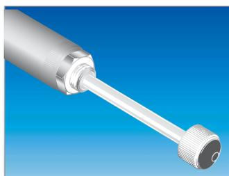
Montare saldamente il cilindro dell'ammortizzatore tramite la sua filettatura, fermanolo con il dado di blocco (fornito), in modo che il suo asse sia in parallelo alla direzione della massa d'urto.
