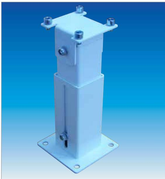
Supporto di fissaggio elettromagnete con colonna allungabile a sezione rettangolare per il fissaggio orizzontale a parete o verticale a pavimento per porte tagliafuoco. Corpo in acciaio verniciato bianco.
