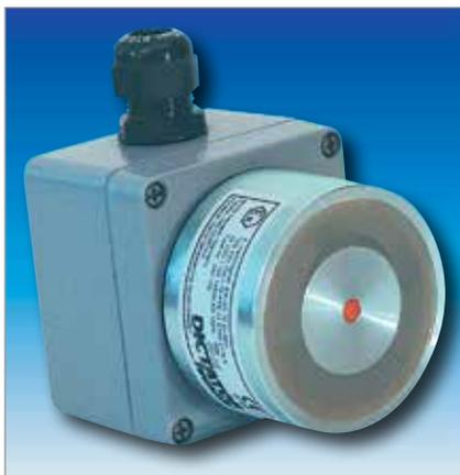
Gli elettromagneti DICTATOR EX antideflagranti sono utilizzati in ambienti a rischio di esplosione in zone di classificazione 0-1-2 piu GAS e 20-21-22 per pulire sono dispositivi compatti composti da elettromagnete, morsetteria antideflagrante, diodo antisintilla per togliere la corrente indotta in apertura e protezione di polarità.
