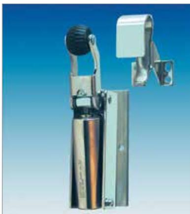
Il chiuditore deceleratore Dictator Z 1100 per porte scorrevoli decelera e chiude tenendo chiuse porte scorrevoli con peso fino a 50 kg. Montaggio corpo chiuditore in verticale sovrapposto alla porta scorrevole con riscontro posizionato sul montante di battuta chiusura della porta scorrevole. Il Dictator Z 1100 è disponibile con forza di chiusura 20-50-80 N, decelerazione regolabile in acciaio nichelato.
