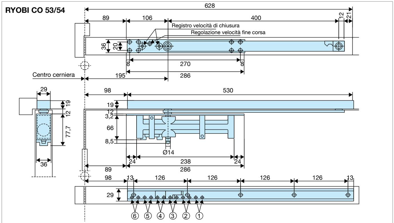
Posizione installazione per angolo di apertura con e senza fermo con decelerazione meccanica e apertura fino a 180°
