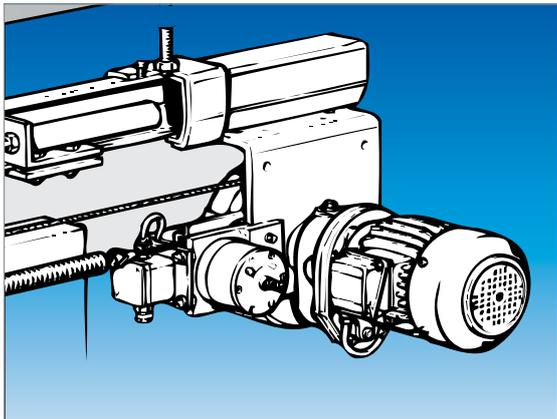
Dictamat 750 è una motorizzazione DICTATOR specifica per porte e portoni scorrevoli antincendio di grandi dimensioni a una o due ante a chiusura centrale dotati di contrappeso.
