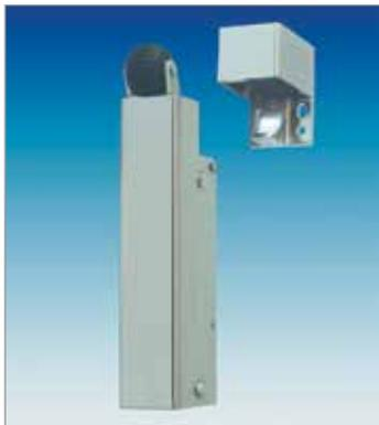
Il chiuditore deceleratore DICTATOR Universal VS Design, grazie al suo carter di copertura a cerniera, non ha nessuna vite di fissaggio in vista e può essere montato in verticale o orizzontale. È disponibile con forza di chiusura da 20-35-50-60-80 o 115 N con decelerazione regolabile cromato lucido o opaco argento colore ottone e in diversi colori RAL.
