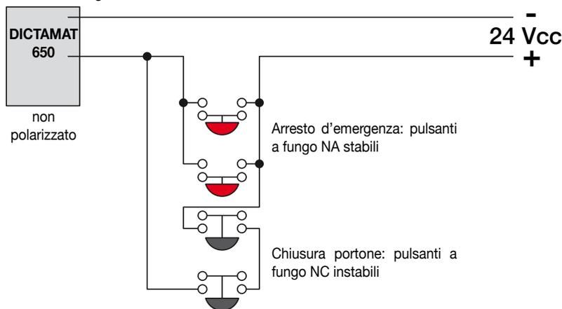
Dalla scheda di zona della centrale antincendio dell'impianto centralizzato dove si collegano gli elettromagneti delle porte
