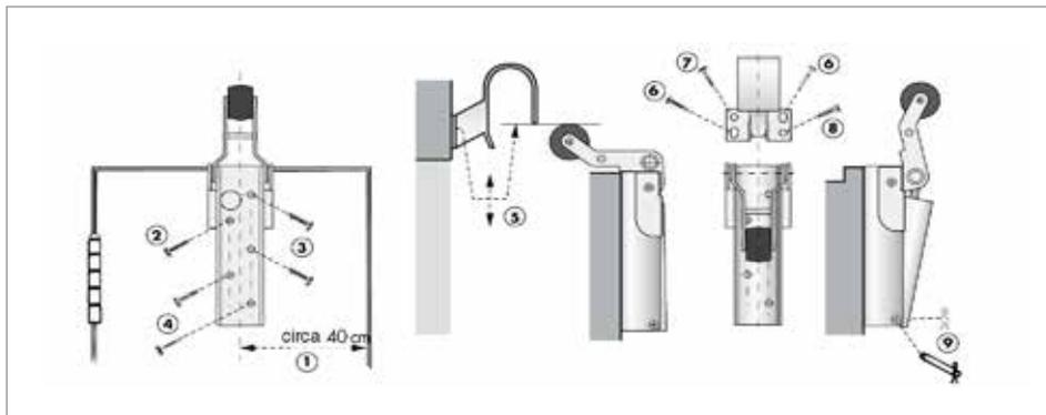
Il chiuditore deceleratore Dictator H1300 con il suo braccio a quattro bronzine è particolarmente adatto a porte pesanti con traffico intenso, montaggio lato tirare della porta in verticale. E' disponibile con forza di chiusura 50-80-115 N decelerazione regolabile in acciaio cromato o nichelato.
