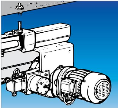
Il Dictamat 700 è una motorizzazione DICTATOR per l'installazione su portoni antincendio industriali dotati di contrappeso in ambiente atex a una o due ante a chiusura centrale.
