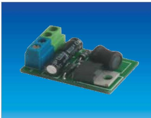
La scheda con convertitore di tensione SCH 504 serve per abbassare e raddrizzare la corrente da 24 Vcc a 12 Vcc.
