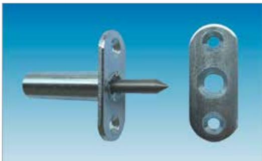
A circa 70-80°C il perno fuoriesce stabilizzando l'anta sul telaio di porte e portoni antincendio, il montaggio può essere sia orizzontale che verticale con il perno rivolto verso il basso. La corsa del perno è 23 mm.
