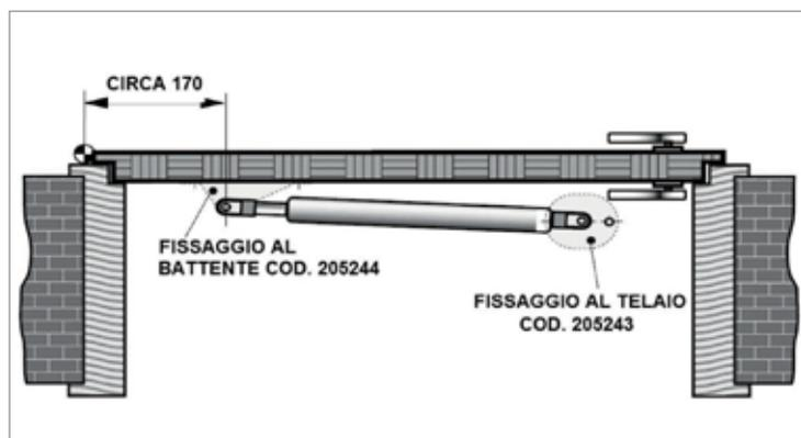
L'ammortizzatore d'apertura DICTATOR serve per ammortizzare l'apertura di porte a battente evitando infortuni causati da aperture improvvise e contraccolpi di pressione aria o vento.
