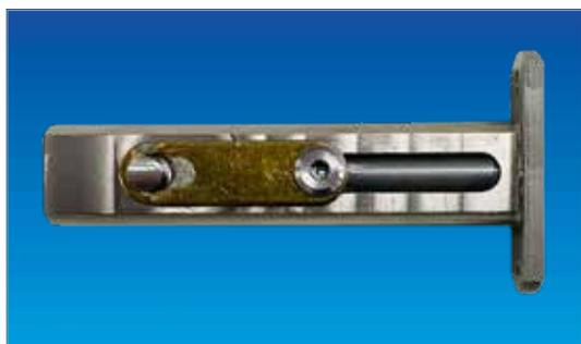
A circa 70°C il perno fuoriesce stabilizzando l'anta sul telaio di porte e portoni antincendio, il montaggio può essere sia orizzontale che verticale con il perno rivolto verso il basso. La corsa del perno è 26 mm fuoriuscito.
