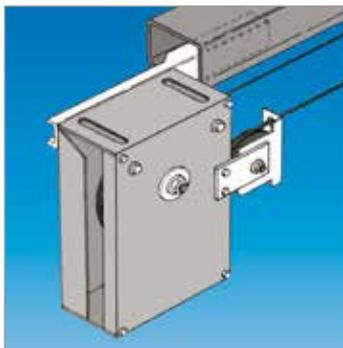
Il Dictamat 650 è un elettroblocco con molla a bobina per portoni scorrevoli antincendio con apertura del portone manuale, chiusura automatica con velocità regolabile su tutta la corsa del portone e arresto antinfortunistico comandato da pulsanti stabili per arresto d'emergenza come da D.L. 81 allegato IV con possibilità di aggiunta di fotocellule.
