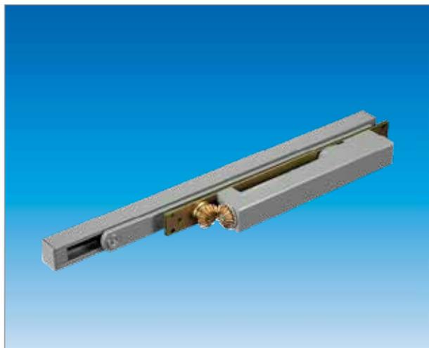
Il chiudiporta DS Dictator DS GZ è un chiudiporta da incasso extracompatto con dimensioni del corpo chiudiporta L.275 compresi ingranaggi per regolazione molla (240 senza ingranaggi) x SP.32 x H.42 mm con forza regolabile da 2 a 4. La velocità generale e la velocità finecorsa sono regolabili separatamente.
