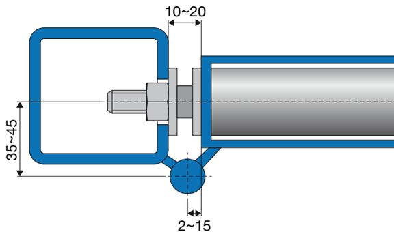
Installazione su porte in legno con battente a filo telaio
