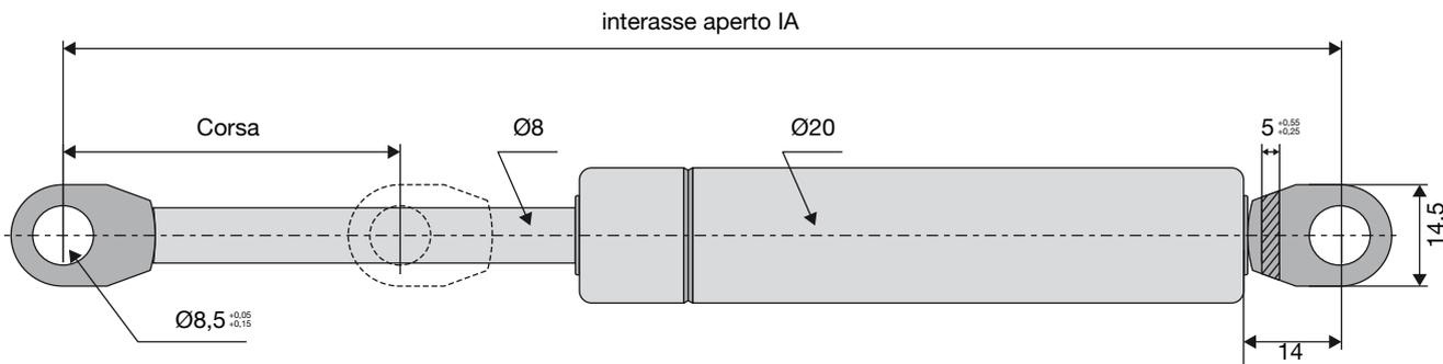
F1 = carico in Newton con stelo esteso (completamente fuoriuscito). Il carico aumenta del 30% con stelo compresso (completamente rientrato).
