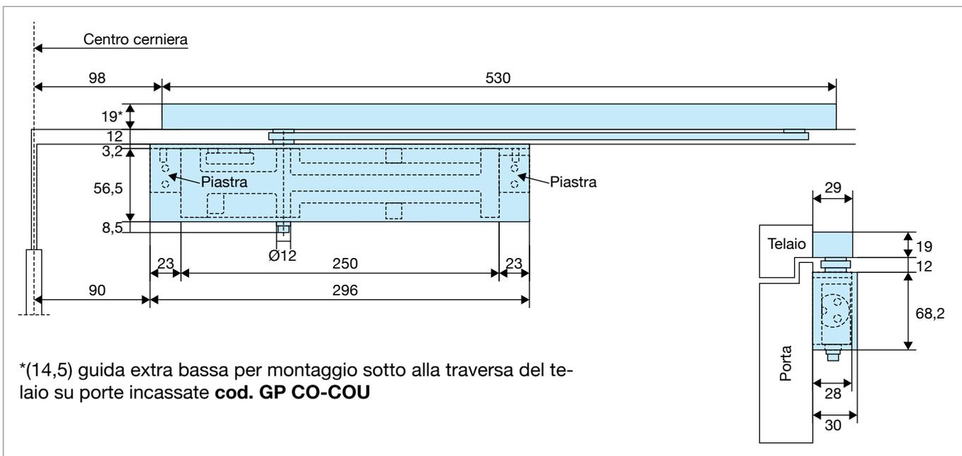
\*(14,5) guida extra bassa per montaggio sotto alla traversa del telaio su porte incassate **cod. GP CO-COU**
