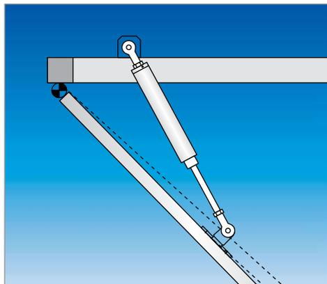
Gli ammortizzatori DICTATOR della serie ODR sono la soluzione ottimale per regolare il movimento rotatorio o di chiusura di portelli pesanti, buratti, vibrovagli, porte isolate di forni, cabine silenziose, porte antiscoppio o radiologiche anche in ambienti in sovrappressione per evitare infortuni. Gli ammortizzatori DICTATOR ODR hanno stelo in acciaio cromato e cilindro in acciaio laccato.
