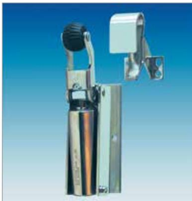
Il chiuditore deceleratore Dictator Z1100 per porte scorrevoli decellera e chiude tenendò chiuse porte scorrevoli con peso fino a 50kg montaggio corpo chiuditore in verticale sovrapposto alla porta scorrevole con riscontro posizionato sul montante di battuta chiusura della porta scorrevole. Il dictator Z1000 è disponibile con forza di chiusura 20 50 80 N decelerazione regolabile in acciaio nichelato.
