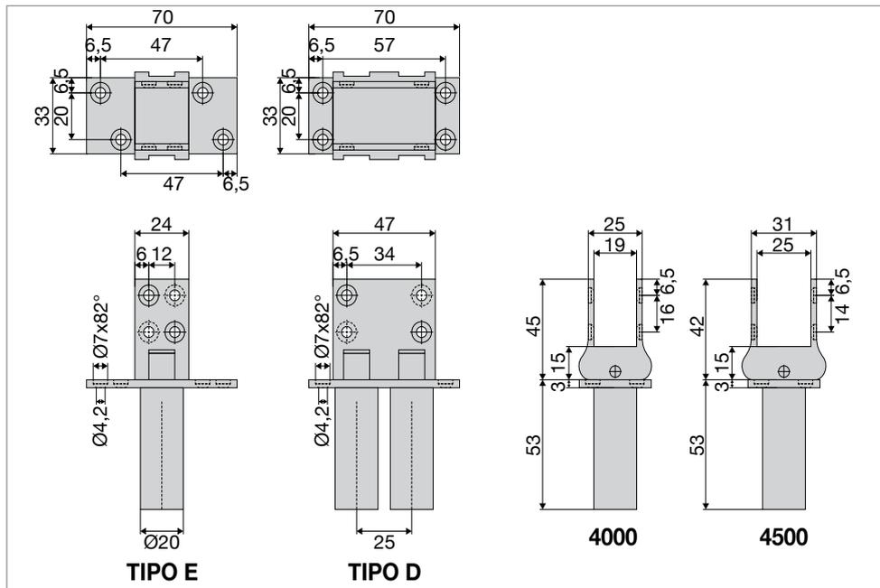
Le cerniere tipo DICTATOR Hawgood 4000 e 4500 sono concepite per porte e portelli sottili. Il tipo 4000 si utilizza su porte con spessore da 19 mm. Il tipo 4500 su porte con spessore da 25 mm.
