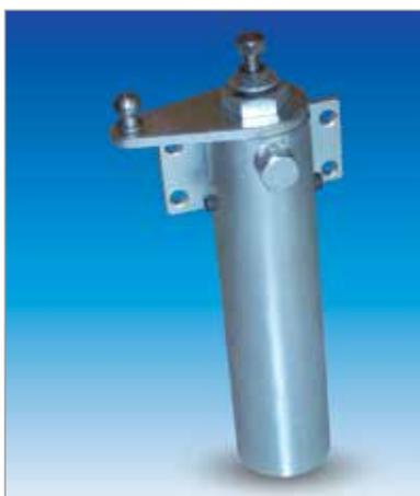
Chiudiporta a incasso - sovrapposto con montaggio su montante verticale del telaio porta (lato spingere) adatto per porte con peso massimo 40 Kg e larghezza massima 800 mm chiudiporta da interno non adatto a traffico intensivo.
