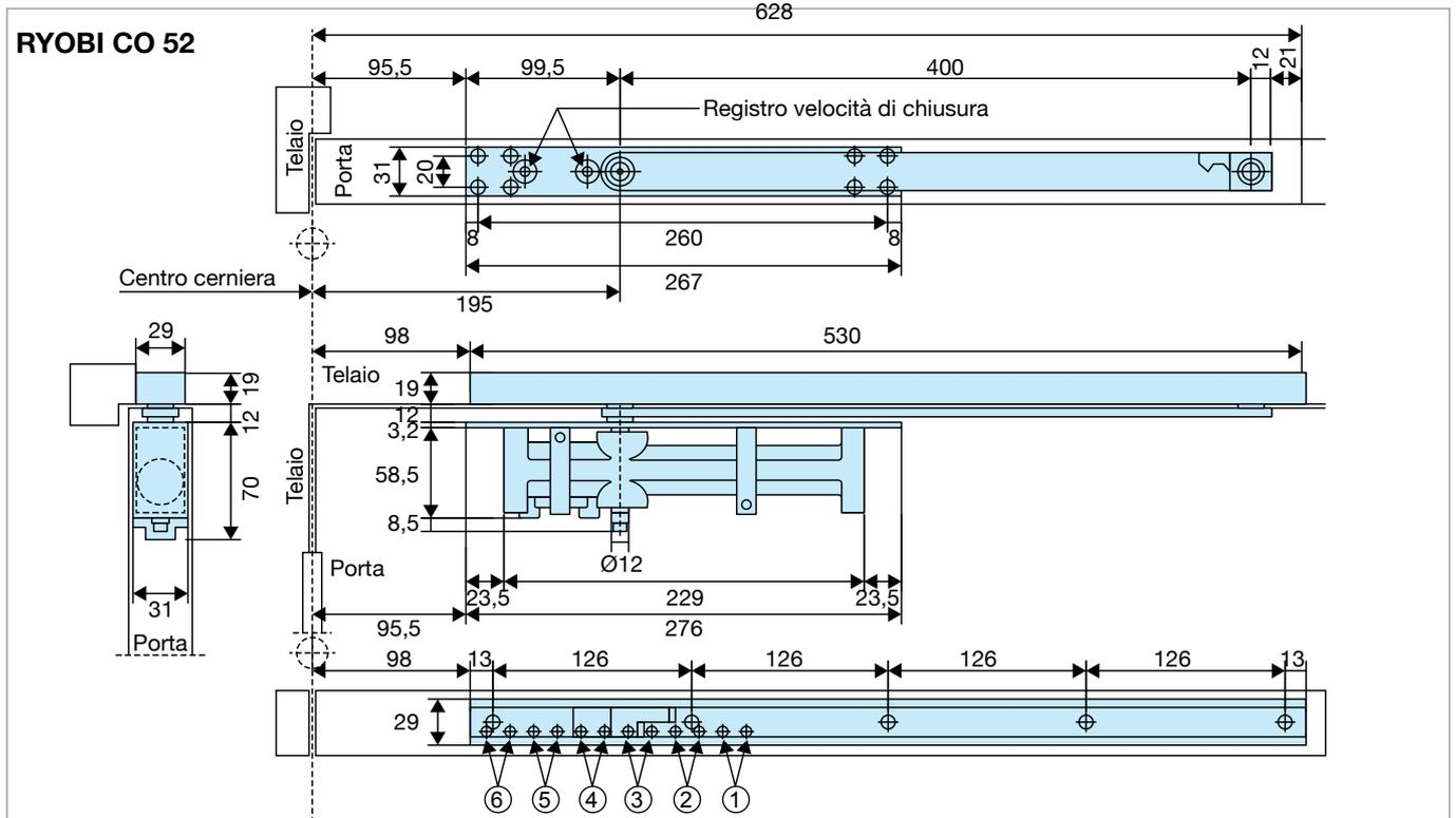
Posizione installazione per angolo di apertura con e senza fermo con decelerazione meccanica e apertura fino a 180°
