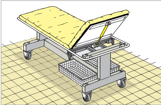
Le molle a gas DICTATOR ad arresto servono a sollevare automaticamente degli oggetti annullandone il peso o per bilanciare il peso e il movimento di questi, come per esempio portelli, bracci di leva, ecc...
