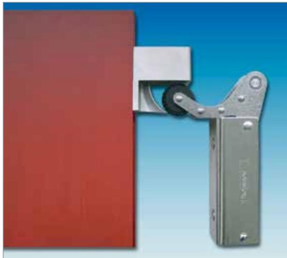
Il DICTATOR TIMER è un fermo meccanico idraulico che ritarda la chiusura di porte scorrevoli o a battente. Decelera l'urto in apertura quindi con il suo registro si regola il tempo di sosta aperto della porta che dopo si chiuderà con molla a bobina Dictator.
