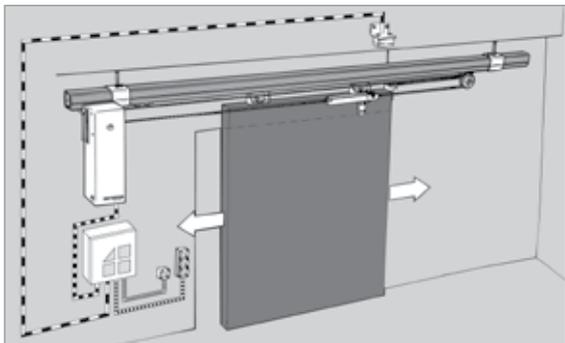
Motorizzazione automatica Dictamat 5700 FMB per ante con peso fino a 1300 kg e lunghezza massima di 6 m.
