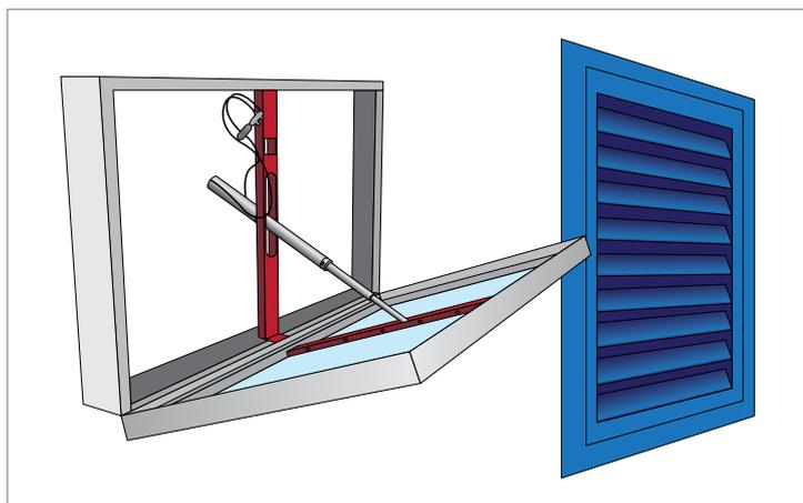
Si forniscono evacuatori di fumo orizzontali certificati completi di cilindro pneumatico con bomboletta CO<sub>2</sub> e valvola con azionamento termico o elettromagnetico per collegamento a impianti di rilevazione antincendio.
