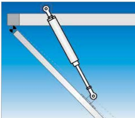
Gli ammortizzatori DICTATOR della serie ODR sono la soluzione ottimale per regolare il movimento rotatorio o di chiusura di portelli pesanti, buratti, vibrovagli, porte isolate di forni, cabine silenziose, porte antiscoppio o radiologiche anche in ambienti in sovrappressione per evitare infortuni. Gli ammortizzatori DICTATOR ODR hanno stelo in acciaio cromato e cilindro in acciaio zincato.
