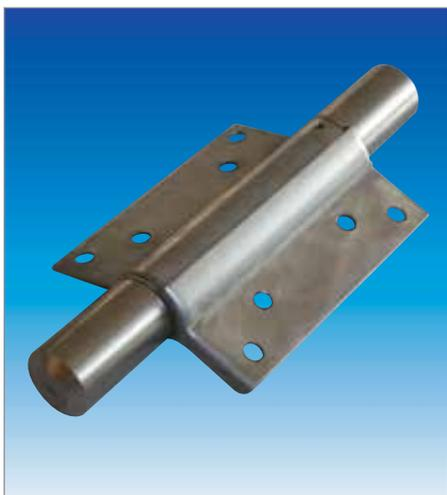
La cerniera a molla DS DICTATOR per piccoli portelli viene utilizzata nelle porte antincendio per il passaggio degli idranti. È realizzato in acciaio inox AISI 304. Il peso dei portelli non deve superare i 15 Kg.
