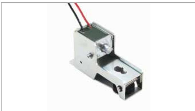
Si installa sulla valvola termica. Quando riceve corrente a 24 Vcc rilascia la fialetta termica in modo da attivare la valvola che perfora la bomboletta di CO<sub>2</sub>. Ha la stessa funzione dell'azionamento elettrico ma è riutilizzabile.
