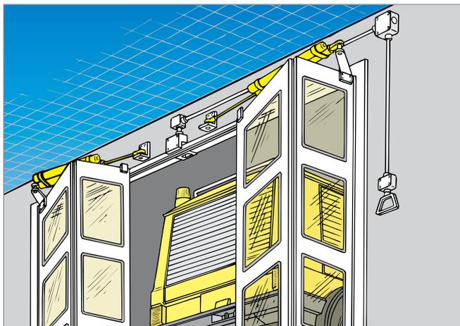
Le molle a gas DICTATOR con velocità di uscita dello stelo regolabile servono per l'apertura o la chiusura di porte e portoni a libro per agevolare l'ingresso d'aria per il moto ascensionale del fumo attraverso evacuatori di fumo, per la chiusura rapida di portoni per contenimento impianti di spegnimento, per portoni ad apertura rapida nelle stazioni dei vigili del fuoco e per il movimento in apertura o chiusura di portoni a libro in genere o per altre applicazioni di movimento.
