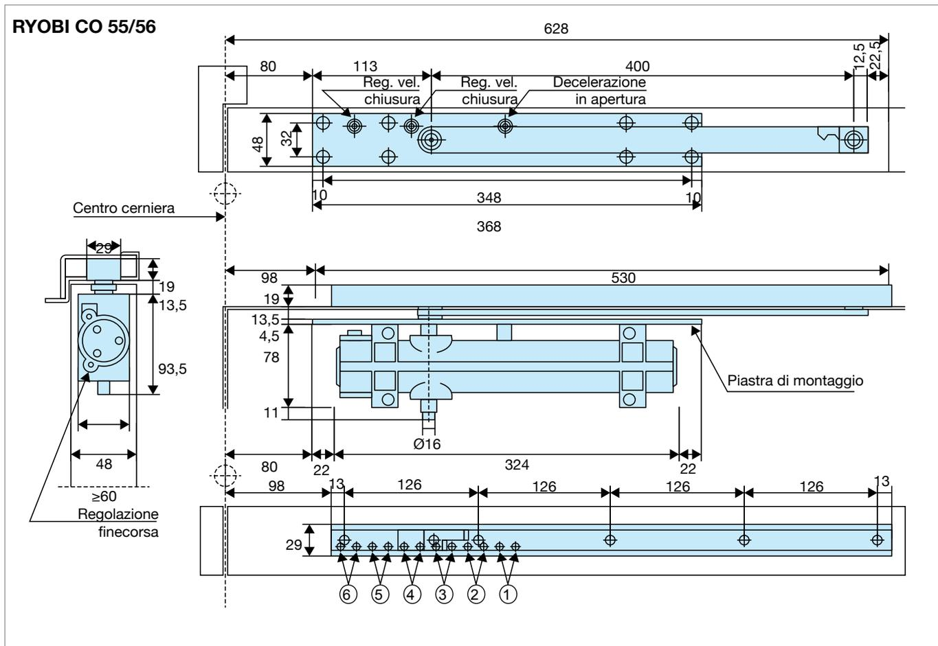
Posizione installazione per angolo di apertura con e senza fermo con decelerazione meccanica e apertura fino a 180°
