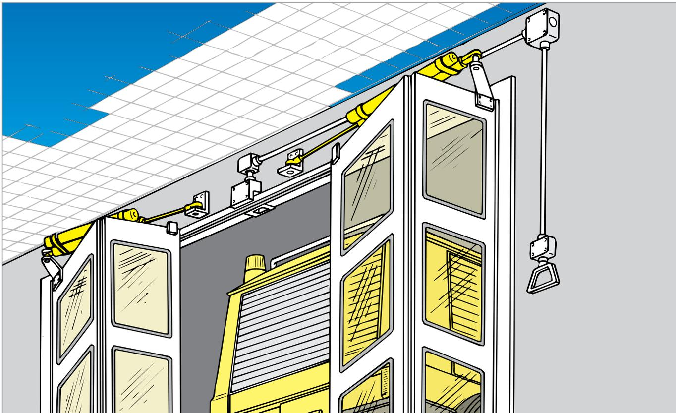
Le molle a gas DICTATOR con velocità regolabile hanno una ulteriore frenatura finecorsa. Trovano impiego soprattutto su portoni a libro che si vuole rendere semi automatici in apertura o in chiusura. Il blocco di tenuta in posizione chiusa o aperta avviene con elettromagnete DICTATOR ad aderenza.
