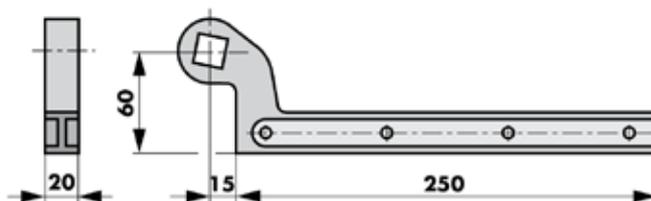
Quando il chiudiporta è incassato sotto lo spessore della porta bisogna usare la cerniera inferiore dritta e la pivotta superiore regolabile. Quando bisogna installare il chiudiporta dietro la porta bisogna usare la pivotta superiore regolabile e la cerniera con braccio per installazione posteriore.
