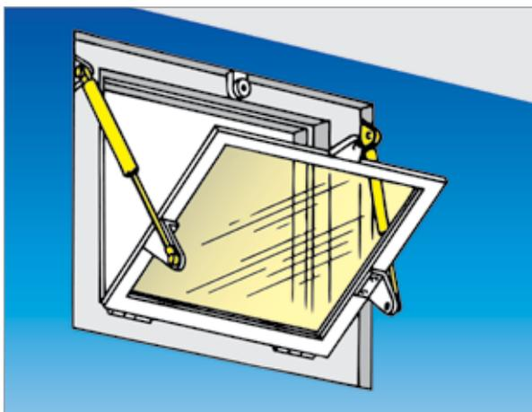
Componenti per trasformare in evacuatori di fumo normali finestre vasistas con cerniera in basso e apertura interno o esterno edificio (necessario mod. pin 2.5 - 2014 cert. imp. firmato da professionista abilitato).
