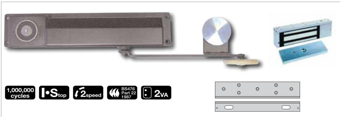
Il chiuditore per finestra antincendio a movimento libero DS RYOBI D2550 EM RF consente dopo che viene “Armato” aprendo una volta l’anta della finestra, l’apertura con movimento manuale dell’anta della finestra dopo avere premuto il pulsante di sblocco lasciando aperta la finestra nella posizione desiderata.
